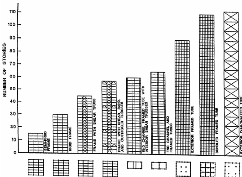
Hình 2. 17. Sơ đồ lựa chọn hệ kết cấu theo số tầng.
